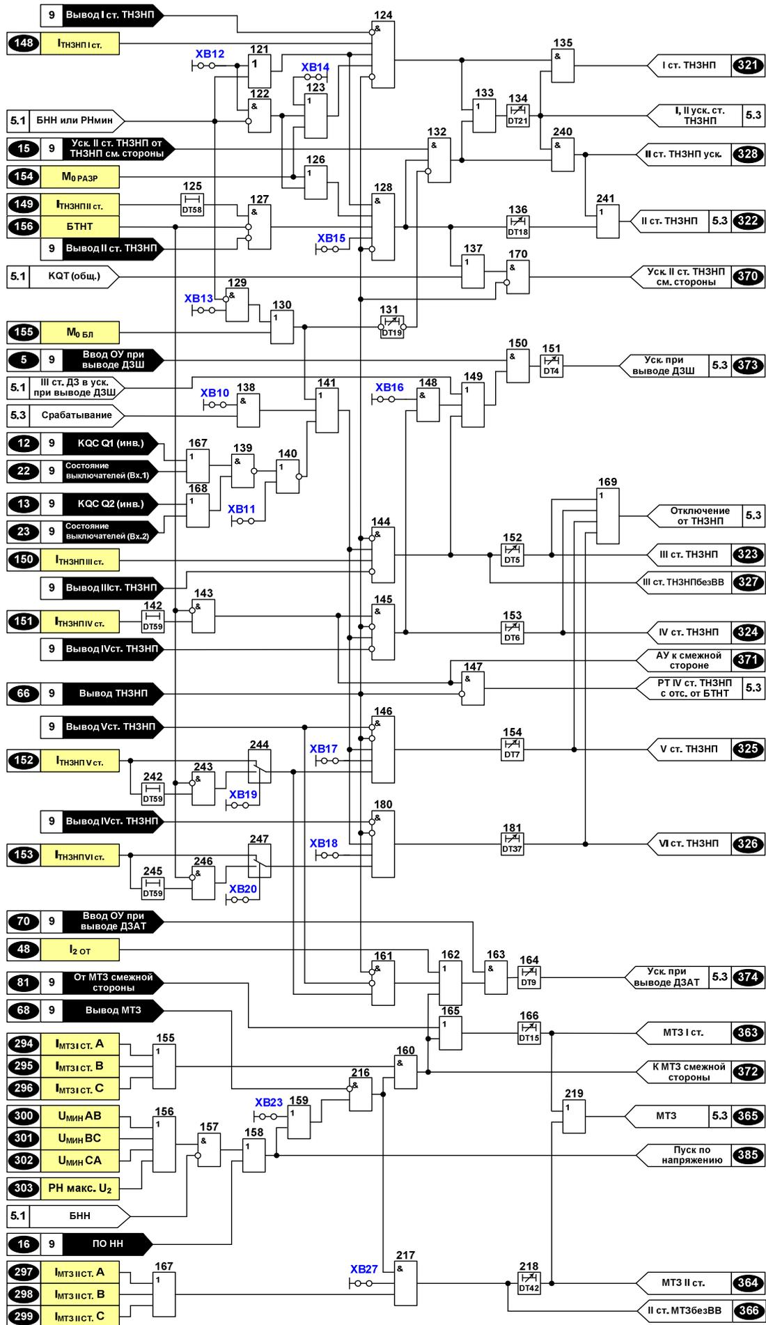
Рисунок 5.2 - Функциональная схема логической части ТНЗНП
