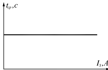
Рисунок 7.1 – Независимая характеристика времени срабатывания защиты от ОЗЗ
